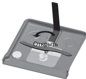
Шаг 1: Поверните блок фильтров против часовой стрелки.
