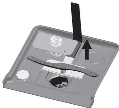
Шаг 2: Снимите блок фильтров, подняв его вверх.
