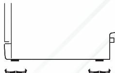
После установки посудомоечной машины её высоту можно отрегулировать с помощью закручивания или выкручивания регулировочных ножек.
